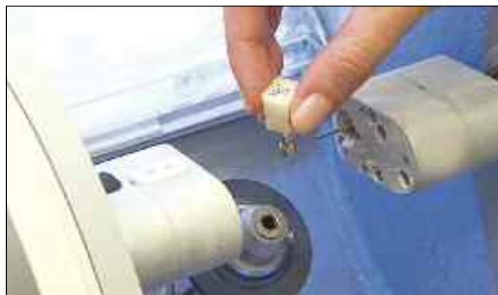
Introduciremos el bloque cerámico seleccionado en la fresadora 3D, la cual reproducirá exactamente el diseño realizado en el modelo virtual obtenido con el escáner intraoral.
