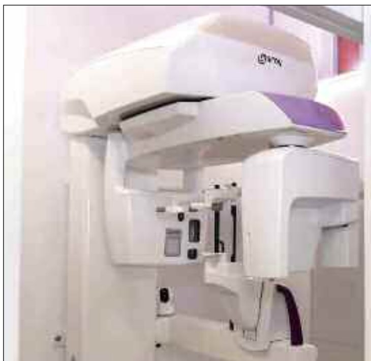
Tomógrafo computerizado de haz cónico CBCT de última generación utilizado en Odontología, obteniendo imágenes 3D.
