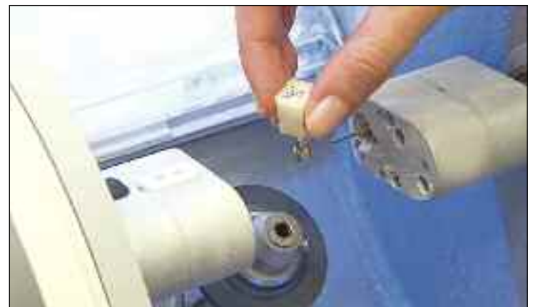
Introduciremos el bloque cerámico seleccionado en la fresadora 3D, la cual reproducirá exactamente el diseño realizado en el modelo virtual obtenido con el escáner intraoral.
